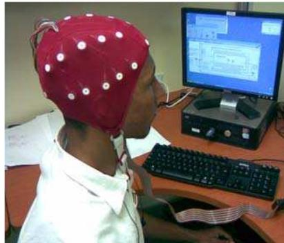
Figura 2. Gorro de electrodos empleado en el sistema
